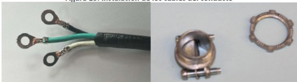
Figura 11: Instalación de la conexión del cable al calentador
